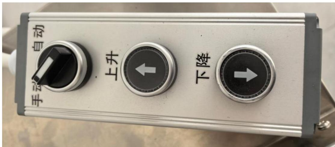
A: 手动/自动旋钮：切换手动/自动状态，打到手动状态时，手操盒其余按键可用，可控制液压缸上升和下降，打到自动状态时，按下其余按键，设备无动作；
